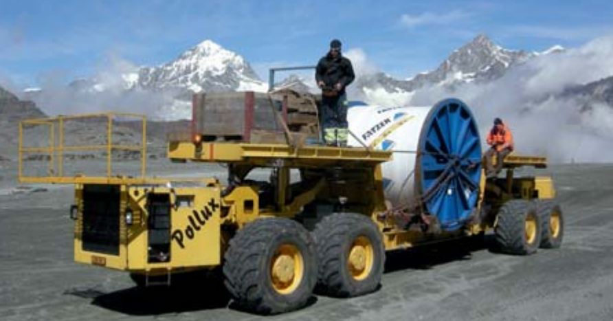
Das Schwertransportfahrzeug „Castor & Pollux“ stellte im August die neuen Zugseile für die PB Trockener Steg – Klein Matterhorn bereit.
