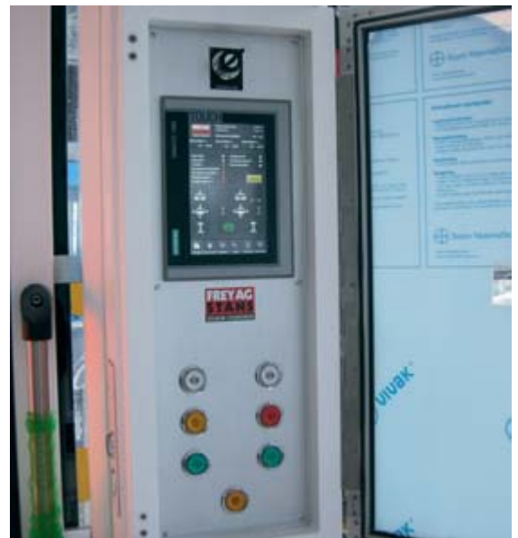
Auch während der Fahrt kann der Kabinenführer unzählige Informationen auf dem übersichtlichen Touch-Panel abrufen.
