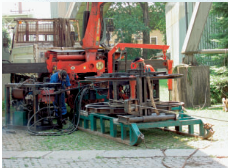
Im Zementwerk Leimen bei Heidelberg (Deutschland): Seilzug als Bestandteil des Seilwechsels.
