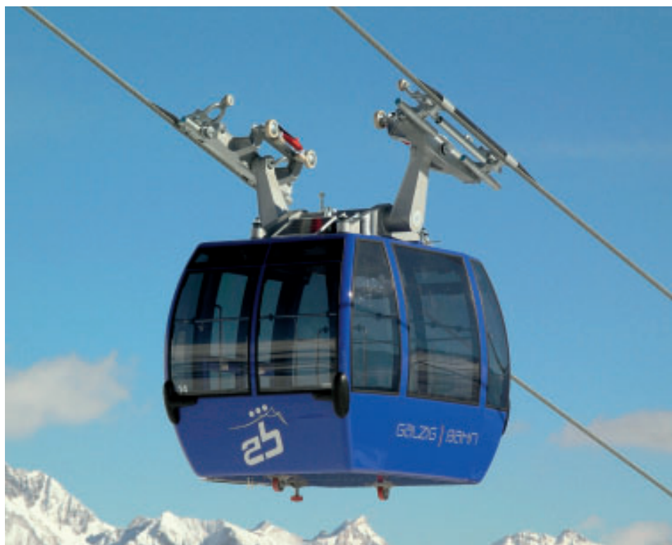
Das Kabinenmodell ZETA wurde speziell für Funitelsysteme und 3S-Bahnen entwickelt. Fotos: CWA
