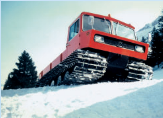
Die erste PistenBully-Serie 32.120 B wurde 1969 mit einem 120 PS starken Sechszylinder-Benzinmotor ausgeliefert.
