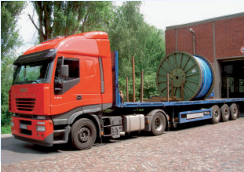
Die 2,8 m hohe und 21 t schwere Stahlhaspel ist bereit für den Transport nach Heidelberg. Fotos: PFEIFER
