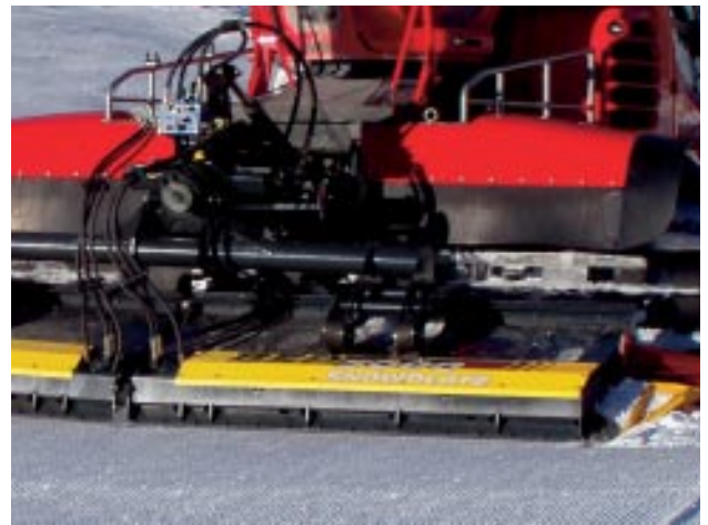
Schritt 4: Einsatz der Snowplate 5000
