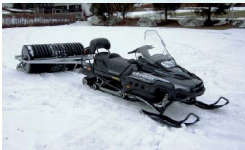
Ski-Doo Skandic V1000 mit Kompaktor-Roller YTS für Skatingtrassen, Ski-Übungshänge und Wanderwege.
