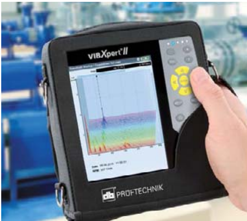
Mit Vibxpert® II kann man Zustandsanalysen an Pumpen aber auch Seilscheiben und Getrieben durchführen. Fotos: Prüftechnik
