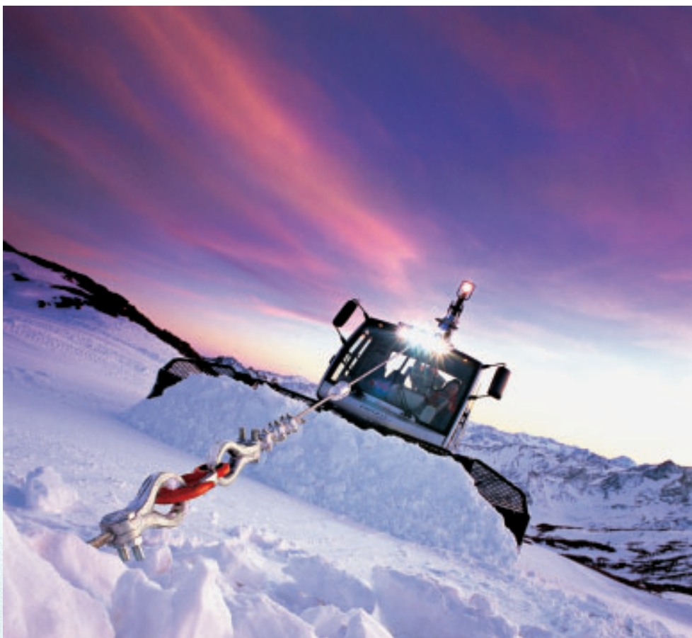
Prinoth Everest Power mit Spillkopfwinde und Teufelberger-Windenseil. Fotos: Teufelberger
