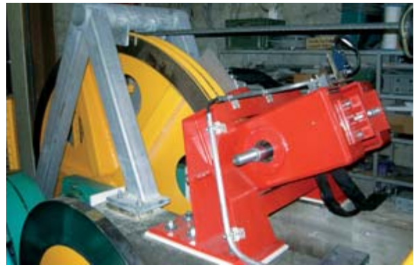
Die Sicherheitsbremse sowie sämtliche Seilscheiben wurden revidiert und auf ihre Funktion überprüft.
