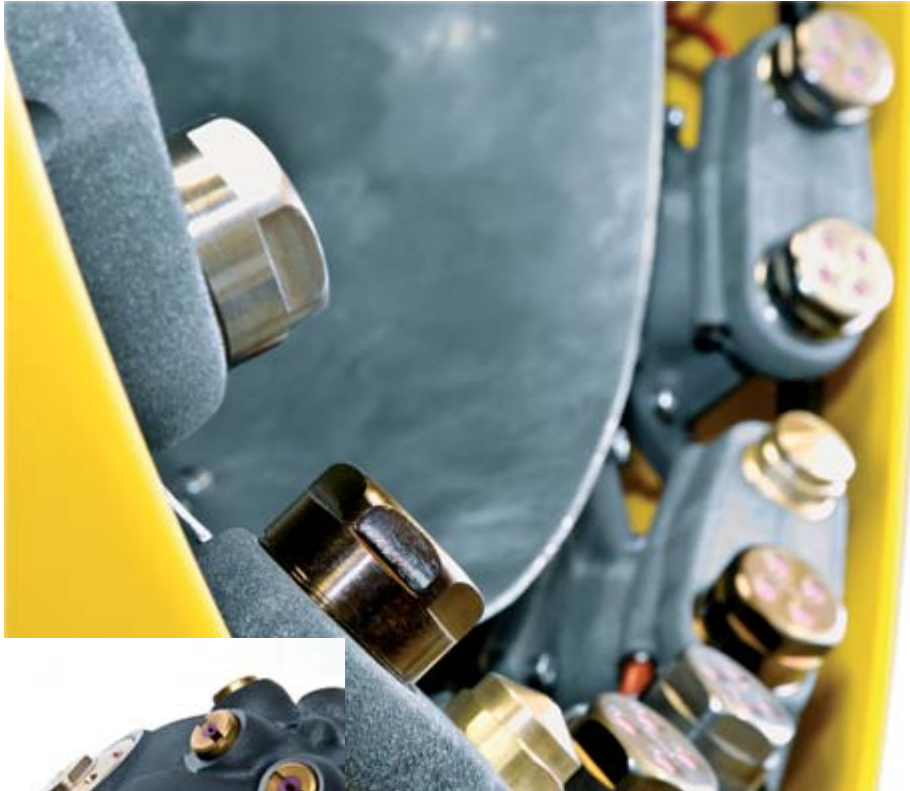
Auch bei der neuesten Propellermaschine T40 setzt TechnoAlpin auf die bewährten Düsen mit Keramikeinsatz. Fotos: TechnoAlpin
