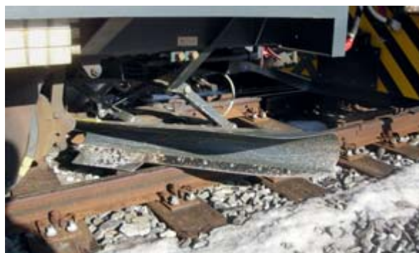
Mit dem Spurpflug wird der Schnee zwischen den Schienen geräumt.
