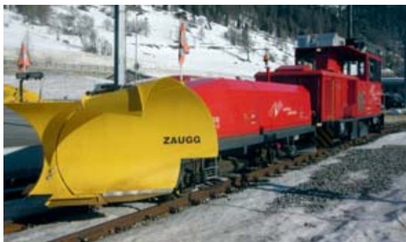
Die Schneerräumungsanlage K20 – Vario von Zaugg AG Eggiwil, aufgebaut auf einem eigenen Wagen der MGB, ist seit der Wintersaison 2013/14 zwischen Brig und Oberwald im Einsatz.
