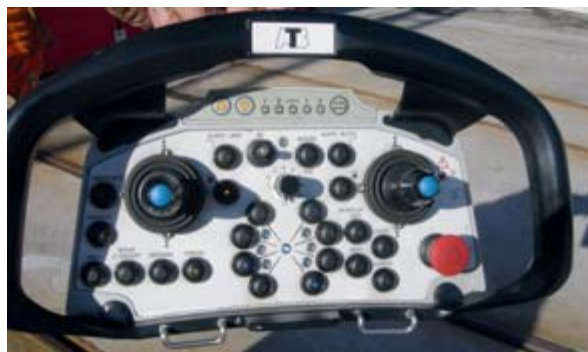
Das Bedienpult ist mit einer Funkfernsteuerung ausgerüstet und mit den beiden Joystick-Bedienhebeln lassen einfach die Scharflügel des Pfluges bedienen.
