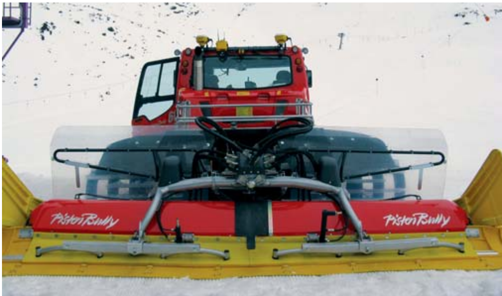
Die Schneehöhenmessung snowMeter wurde sowohl für Kässbohrer- als auch für Prinoth-Pistengeräte konzipiert und u.a. von den Skiliften Hochfügen im Zillertal im Einsatz getestet. Fotos: Trimble
