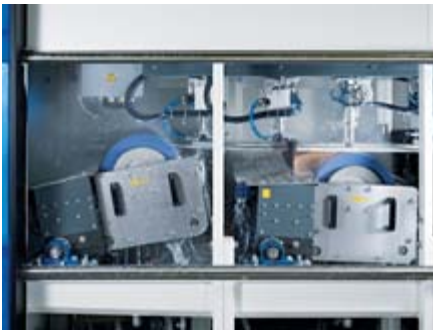
SAPHIR in Aktion: Skiende und Schaufel werden ausgeschliffen. Fotos: MONTANA
