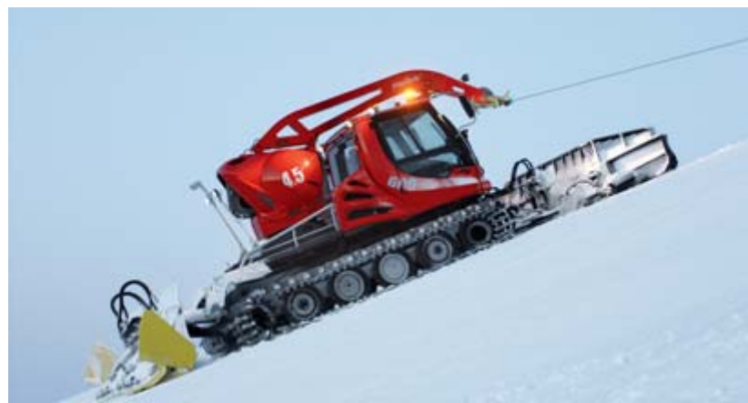
Der PistenBully 600 W mit der neuen 4,5 t Winde.
