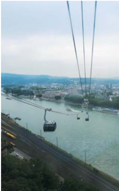
Fatzer-Seile sorgen für Beförderungsrekorde: Max. 7 600 P/h bringt die Koblenzer BuGa-Bahn trocken über den Rhein. Die Integra-Tragseile mit integrierter Glasfaser-Datenleitung sind 54mm dick und wiegen 17 Tonnen
