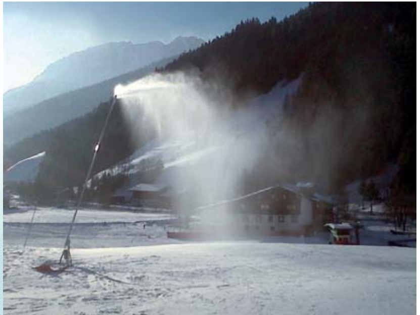
Der neue Lanzenschneerezeuger Ecostick braucht nur noch Wasser unter Druck und sonst keine weitere Energie. Fotos: Nivis
