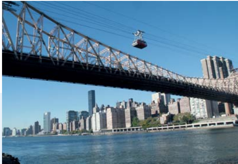
Die Pendelbahn von New York benötigt keine Bergbahn, weil das System redundant ausgeführt wurde.
