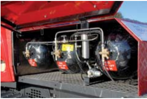
Zusatztank für CNG auf der Ladefläche. Foto: Kässbohrer Geländefahrzeug AG
