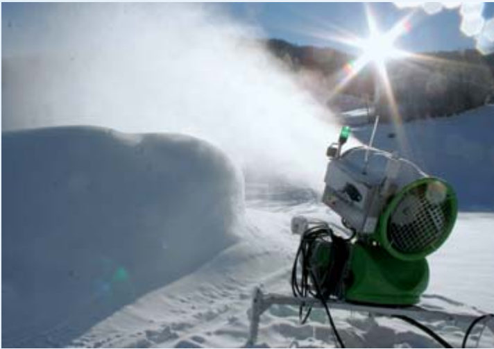
Auf der Reiteralm ist eine „sortenreine“ SUFAG-Schneeanlage im Einsatz, die letztes Jahr auf 120 Propellermaschinen erweitert wurde.
