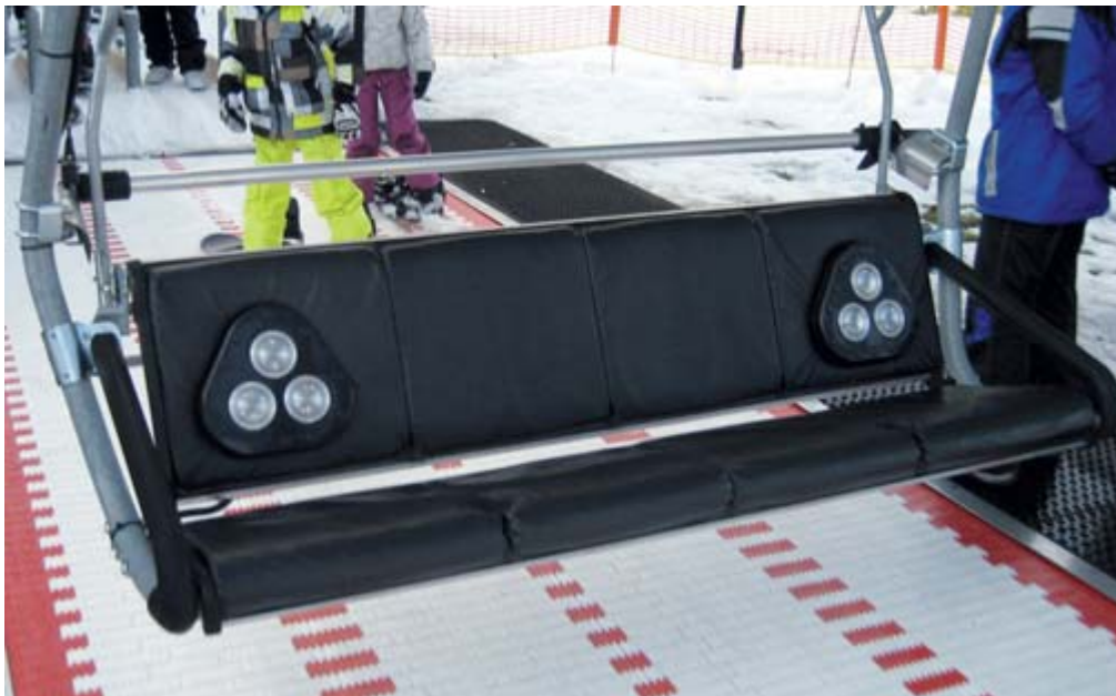
Österreich-Premiere von Magnostick: Beim 4er Sessellift „Schneebergbahn“ der BB Westendorf verfügt jeder Sessel über 2 Sitzlehnen, die mit einem dreifach Permanentmagneten ausgerüstet sind.
