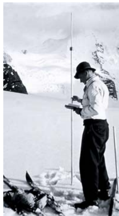
Messung der Schneehärte mit der Rammsonde 1937. Fotos: SLF
