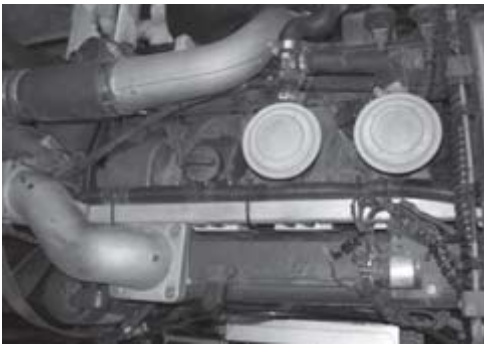
Gas wird im Ansaugtakt der Verbrennungsluft zugeführt. Foto: Kässbohrer Geländefahrzeug AG
