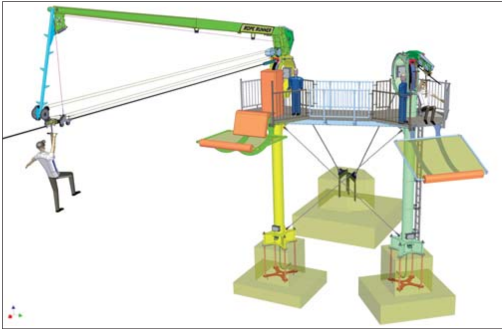
Grafik Mittelstation mit XXL-Stützen für ein vollverschlossenes 26iger Seil, Bremssystem SMARTrun. Links Ankunft, rechts nächster Start.
