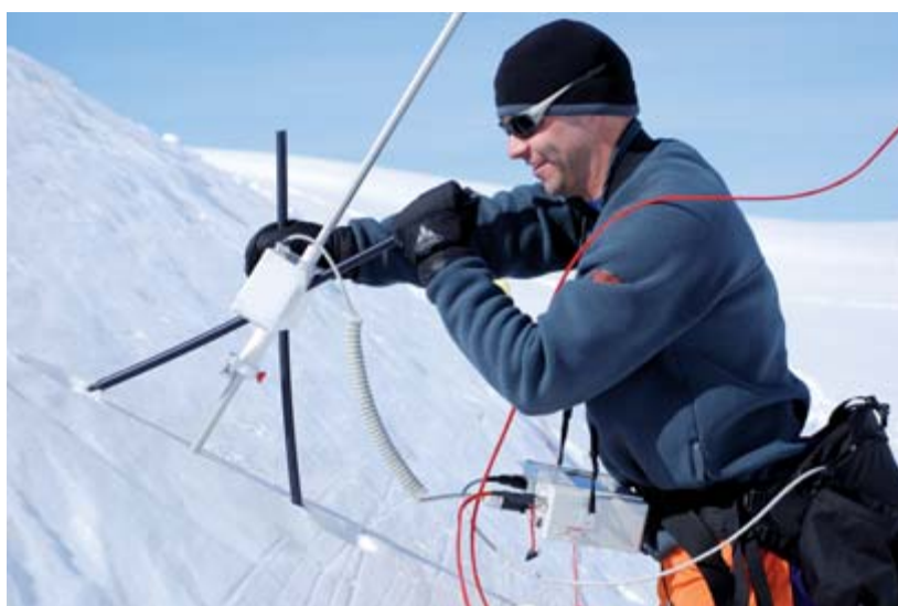
Messung der Schneehärte mit dem SnowMicro- Pen 2009.
